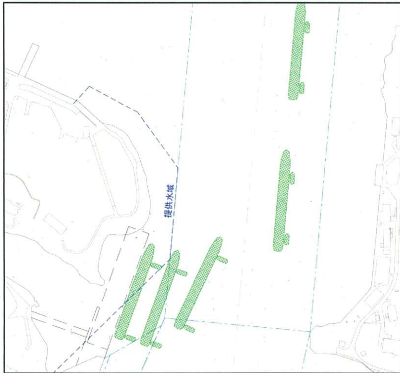
図 II - 4 出港操船の一例
